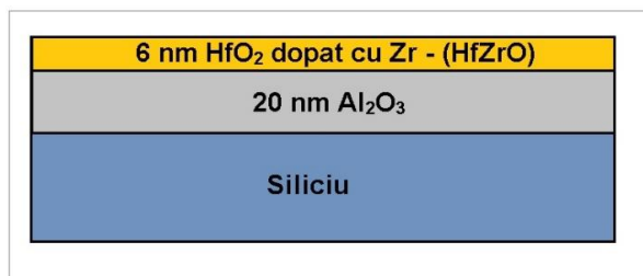
Fig. 2.1.1 Reprezentarea schematica a filmelor ultra-subtiri cu strat dublu - 6 nm HfZrO / 20 nm Al 2 O 3 , crescute pe substrat de Si
